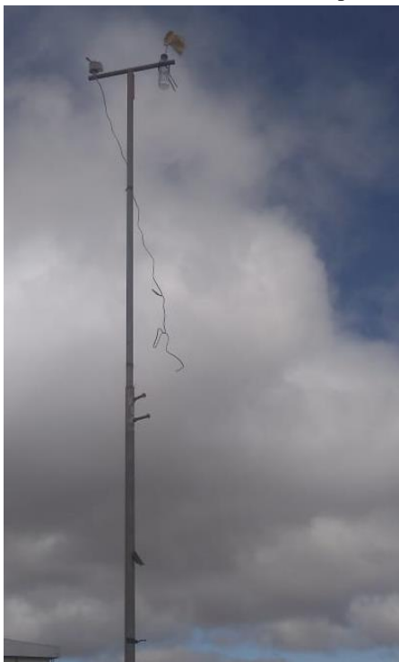
Figura 7: Teste com sensor WH2081 e biruta manual com aproximadamente 10 m de altura
