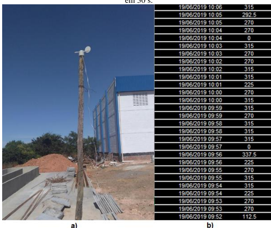
Figura 4: a) Sensor com aproximadamente 3.5 m de altura e b) Dados do servidor com intervalo de 30 s em 30 s.
